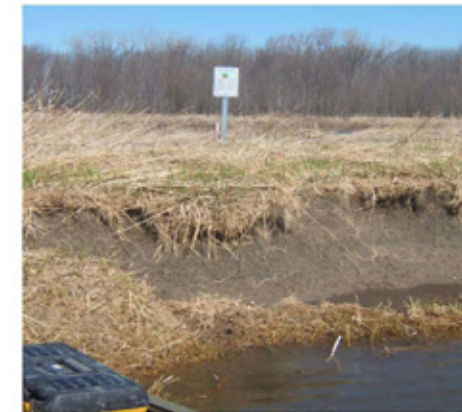
Exemple de piquets utilisés pour mesurer le taux de récession des rives (L.F. Richard, Environnement Canada)
