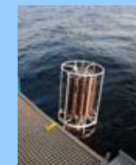
Mise à l'eau de la « Rosette » pour la collecte d'eau à différentes profondeurs. L'eau est analysée pour déterminer la concentration en sel nutritifs et l'identification des espèces de phytoplancton.
